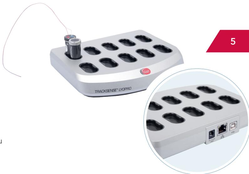
La reader station portatile LyoPro non richiede manutenzione. È composta da una solida struttura in alluminio anodizzato con una base in polimero e incorpora una porta ethernet. Gli indirizzi IP e MAC sono chiaramente riportati sulla parte inferiore della reader station - permettendoti di connettere e configurare facilmente il dispositivo in ValSuite. In alternativa, è possibile utilizzare la reader station in modalità plug-and-play via USB.
