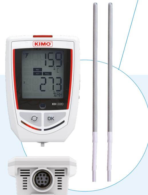
Registra la temperatura all'interno di una struttura di stoccaggio per prodotti termosensibili (come ingredienti farmaceutici, prodotti finiti e alimenti deperibili): uno strumento può eseguire fino a tre letture di temperatura contemporaneamente (due sonde esterne e una sonda interna).
